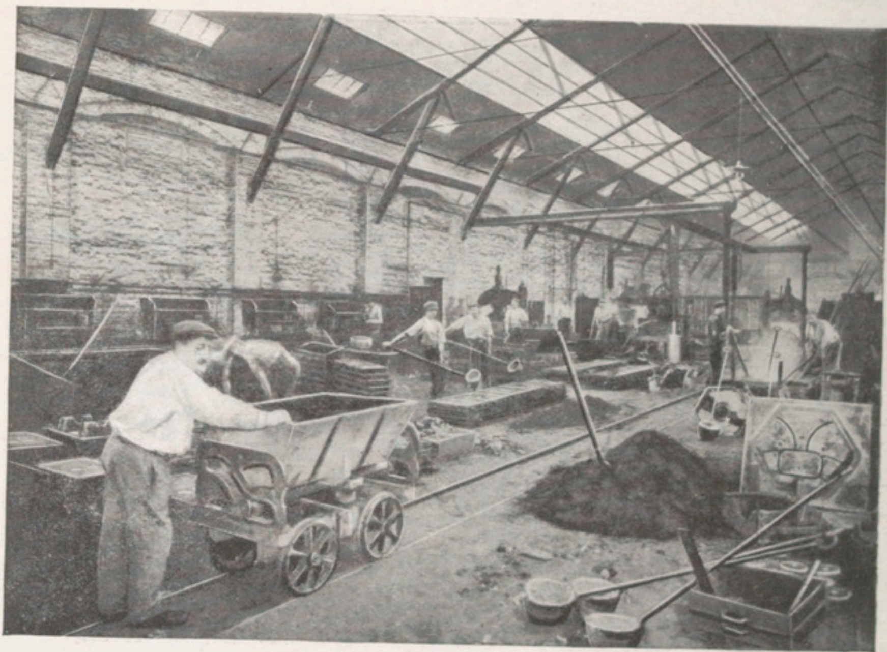
Une partie de la Fonderie de Guise reconstituée. — Les presses à mouler.
